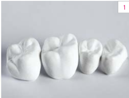
Abb. 1 CAM-gefertigte Kronen aus dem Zirkondioxid VITA YZ HT. Hinweis: Vor dem Einfärben die gesamte Okklusalfäche leicht mit feinen Diamanten überschleifen, um eine gute Flüssigkeitsaufnahme zu ermöglichen.
